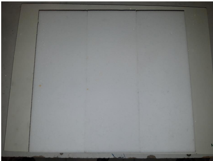
Aspecto de la muestra antes del ensayo de inflamabilidad según EN ISO 11925-2 (aplicado en superficie)
