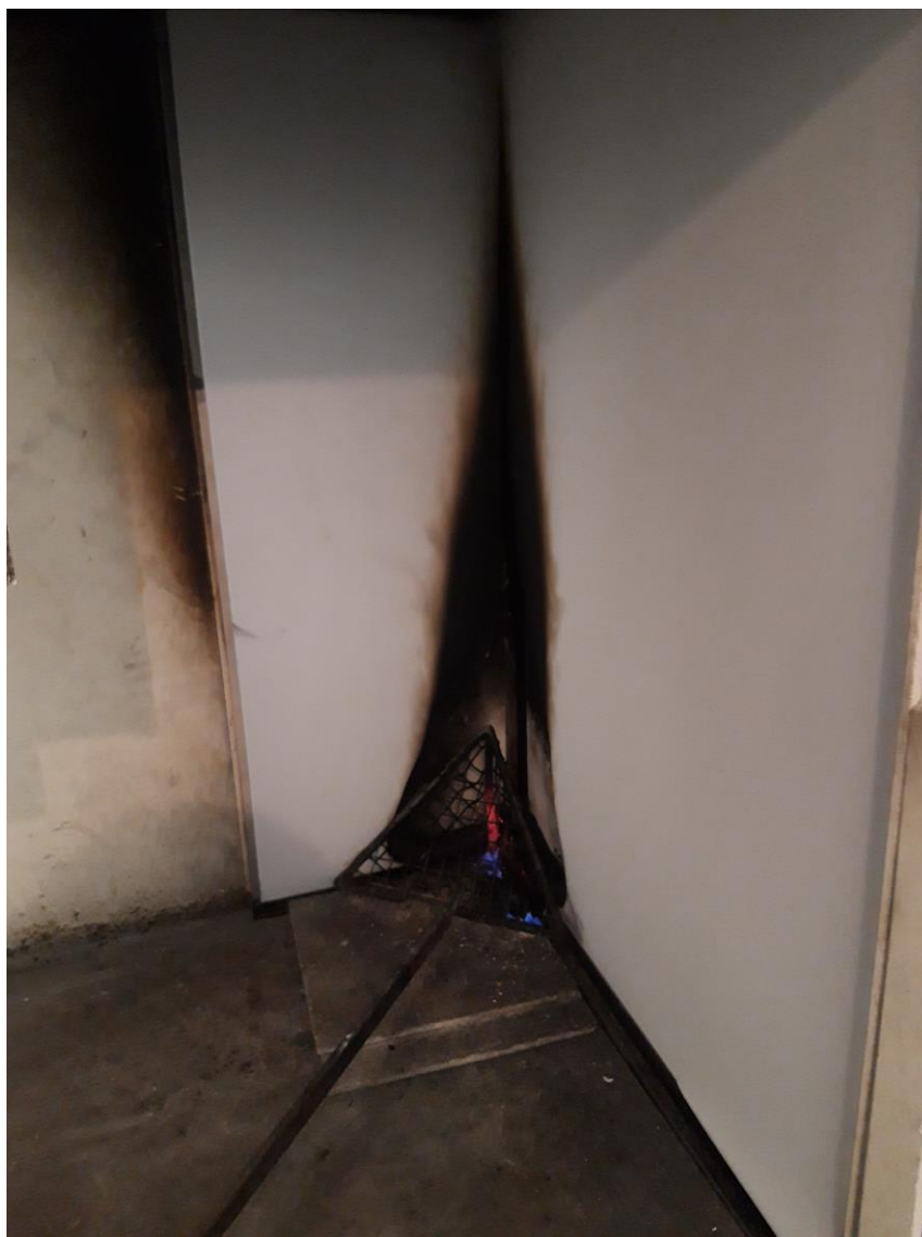
Aspecto de la muestra tras el ensayo de SBI según EN 13823
