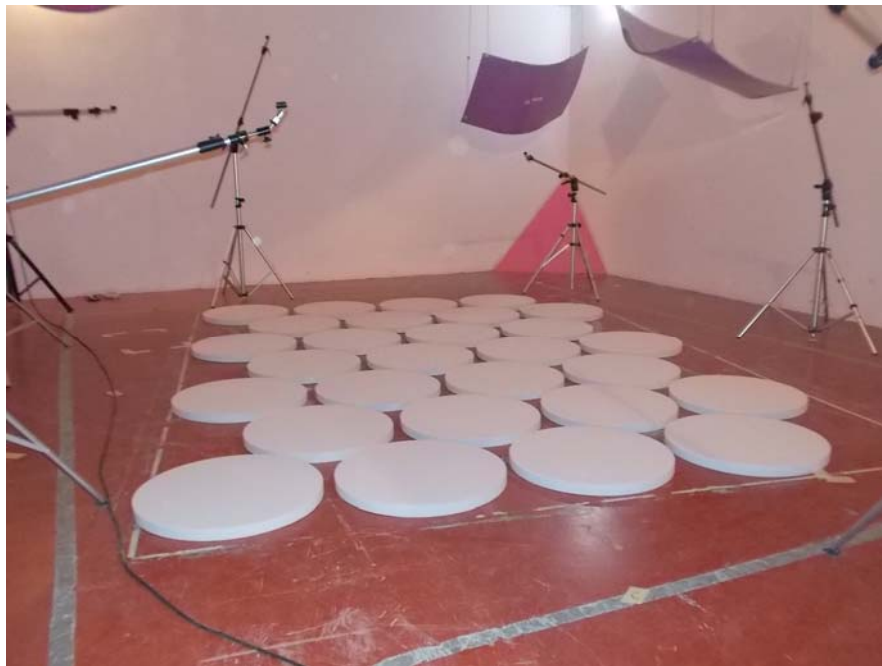
Foto 2: Vista de muestra de ensayo en cámara reverberante
